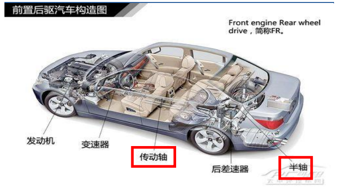
图 34: 前置后驱传动系统结构
