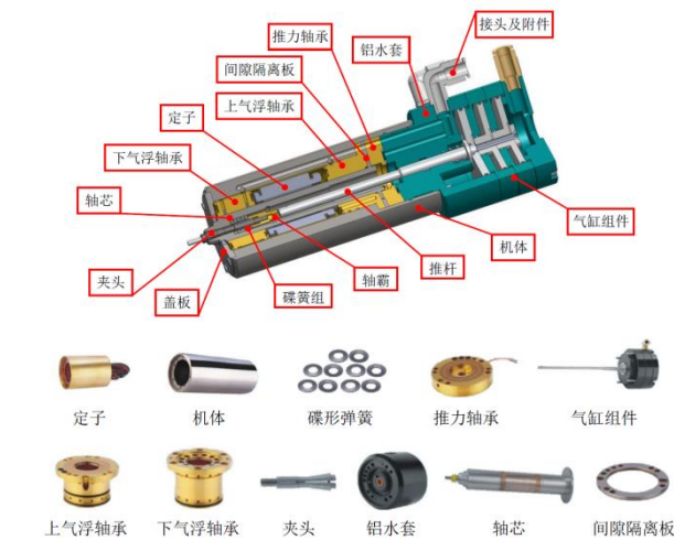
图 19：电主轴拆分图
