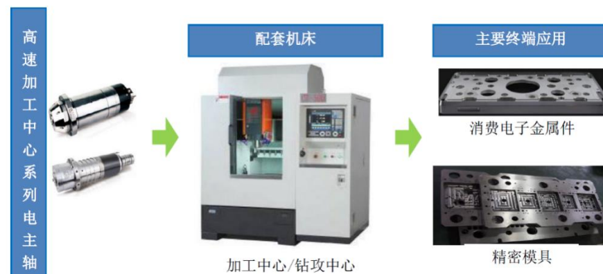
图 16: 高速加工中心生产流程及电主轴应用范围
