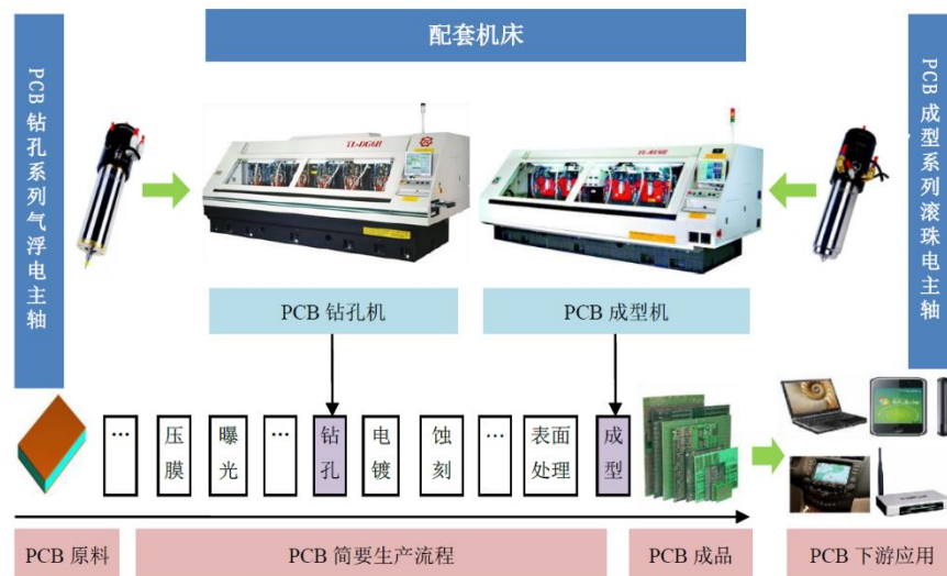
图 18: PCB 钻孔机、成型机生产流程及电主轴应用范围
