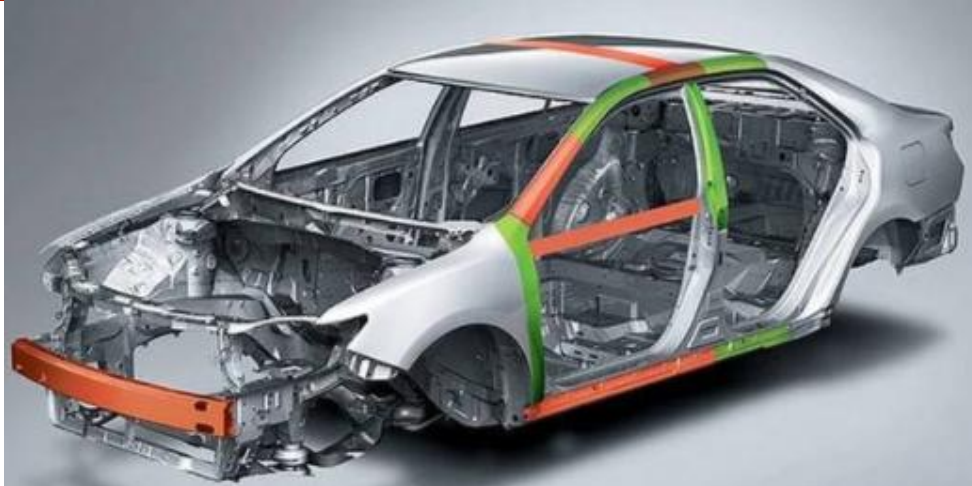
图13：热成型件应用于车身的重要位置
