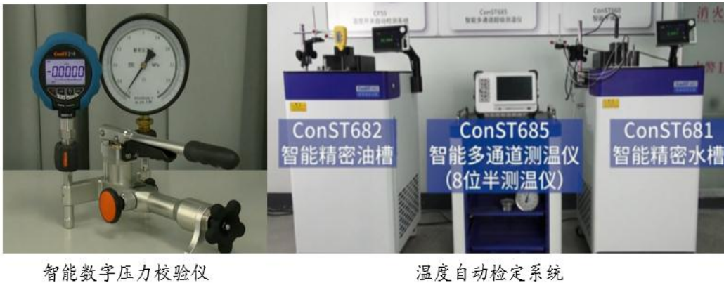
图 12: 常见的数字压力检测仪器仪表与温度校准仪器仪表
