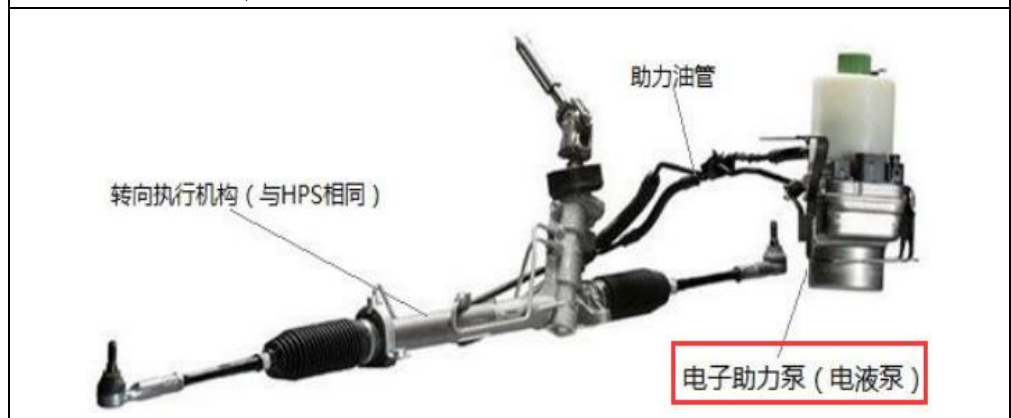
图 17: EHPS 工作原理示意图
