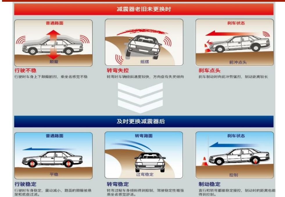
图 20：汽车悬架系统减震器对车辆行驶、转弯及制动稳定性起到重要作用
