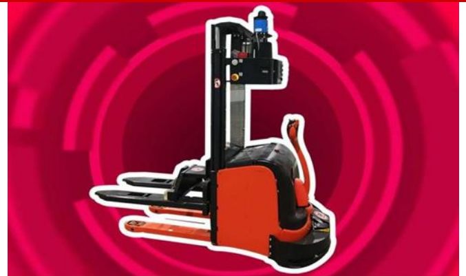
图 9 翔港科技 AGV 智能化无人驾驶叉车
