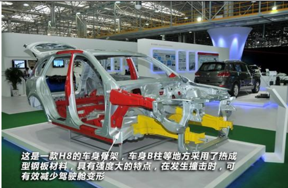
图 24: 车身关键部位采用热成型钢能提高车辆抗碰撞能力和整体安全性
