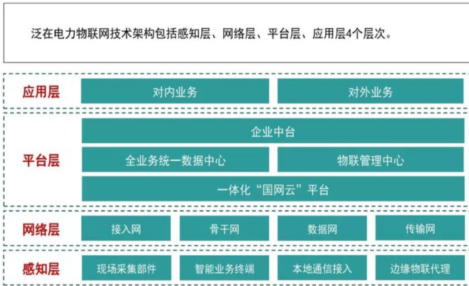
图表 14: 泛在 4 个应用架构
