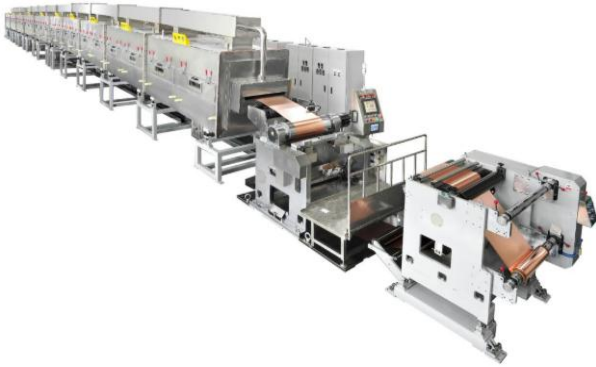
图 20: 浩能科技涂布机示意图
