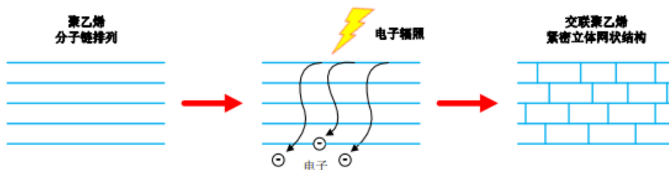
图 16: 电子辐照交联技术原理示意图
