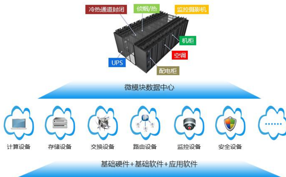
图表 25 微模块数据中心组成
