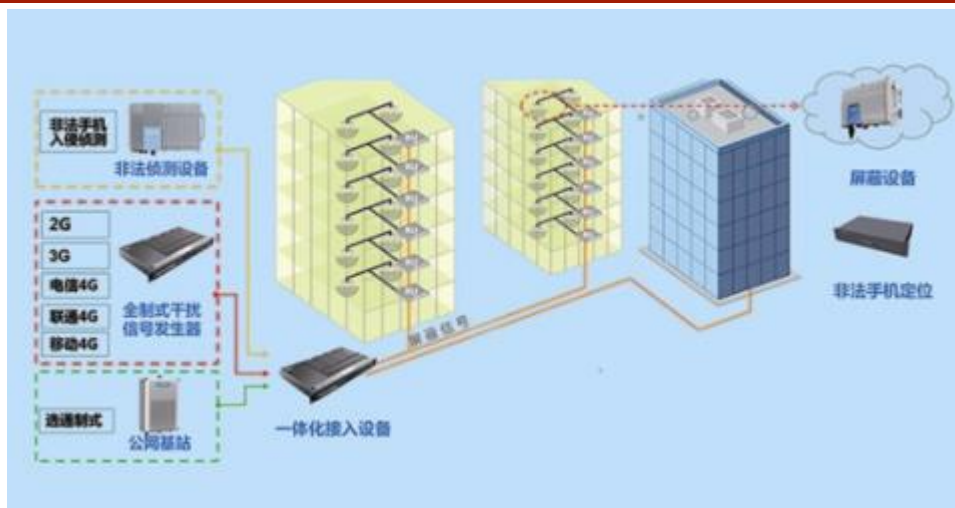
图18：监狱信号管控系统示意图
