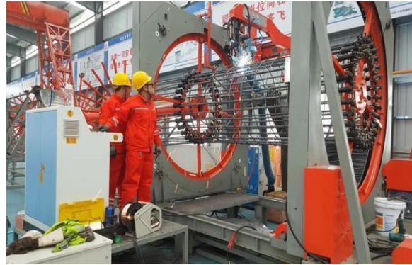
图表33：钢筋集中加工中心的全自动数控钢筋加工装备
