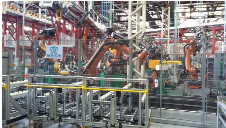
图 7：瑞弗机电机器人焊接工作站
