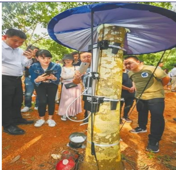
图 47、“一机一树”式割胶机器人
