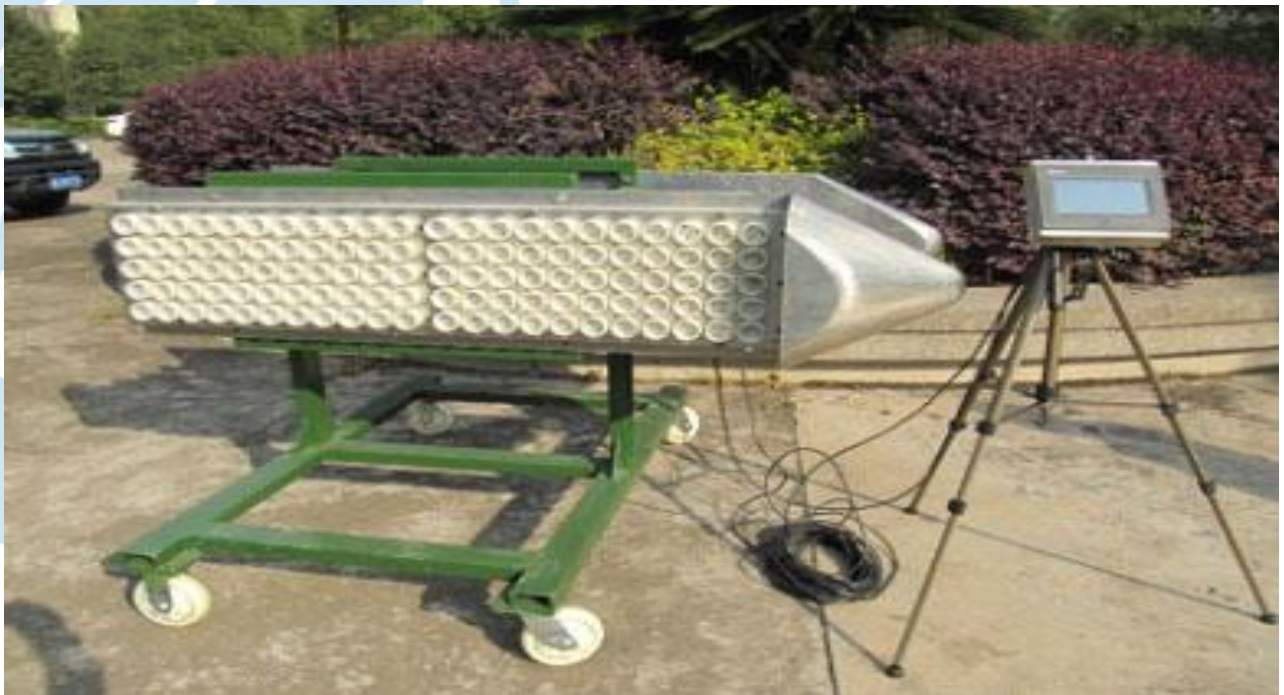
图 21：BYF110-2 型机载下投式焰弹播撒器
