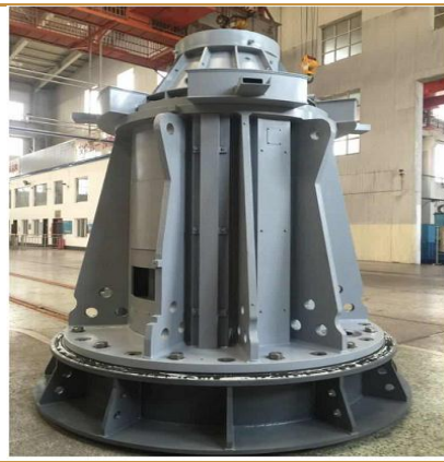
图 10：主氮风机驱动电机
