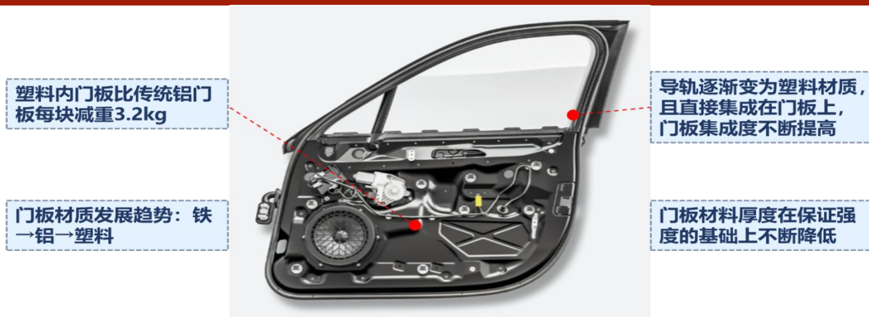
图表 14：轻量化汽车门板工艺和优点
