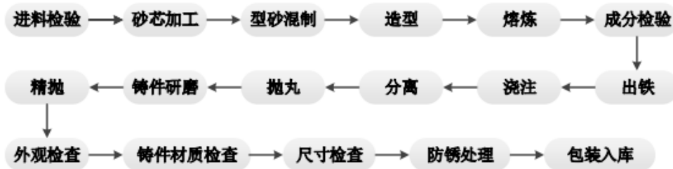
图 25: 涡轮壳、中间壳铸造工艺流程
