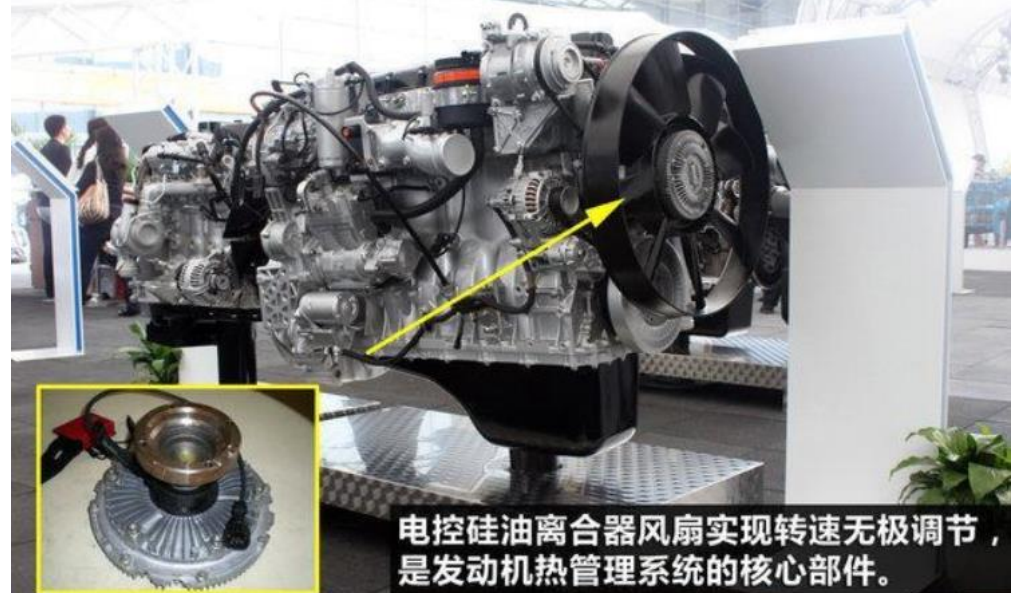
图 16: 采用电控硅油离合器风扇的发动机
