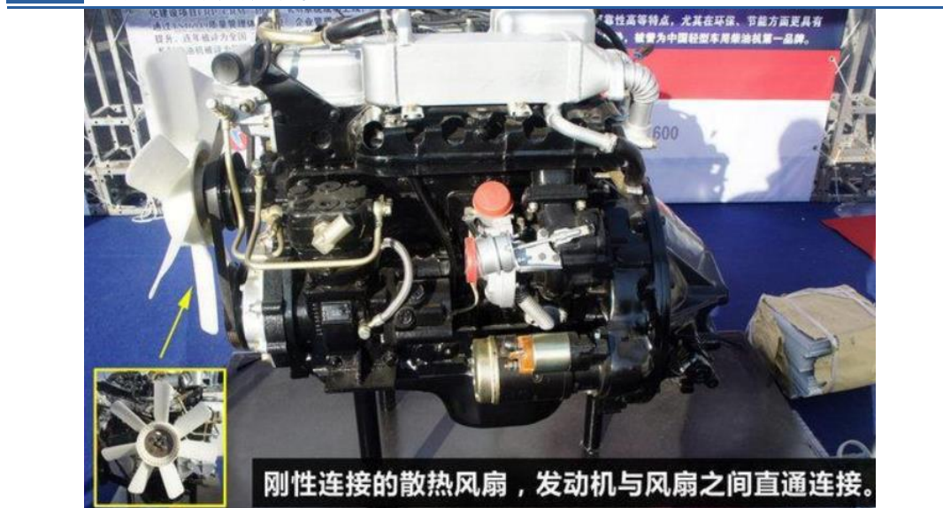
图 12: 采用直连风扇的发动机
