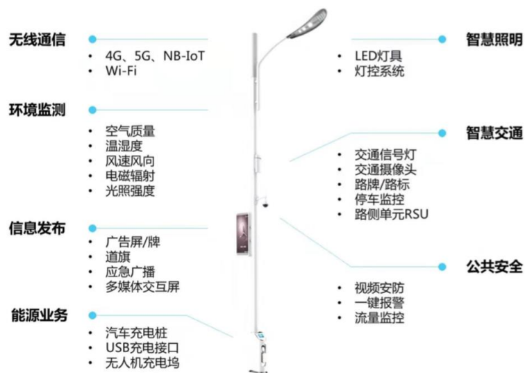
图 17: 智慧路灯集多功能为一体
