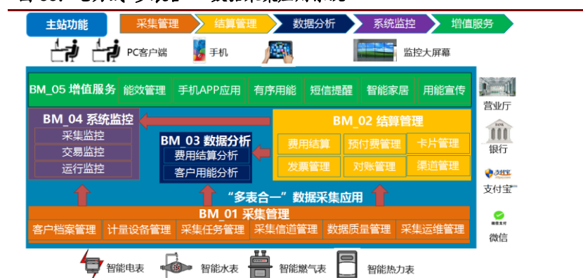
图 35: 电力线“多表合一”数据采集应用系统
