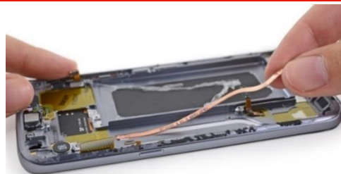
图表21: 三星 Galaxy S7 使用的超薄热管
