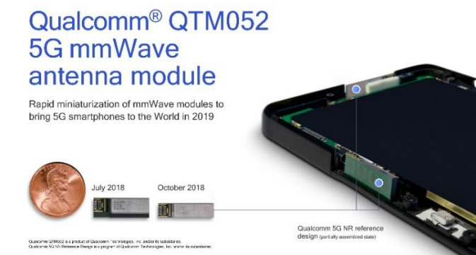
图表47: 高通 QTM052 毫米波天线模组智能手机布置方案
